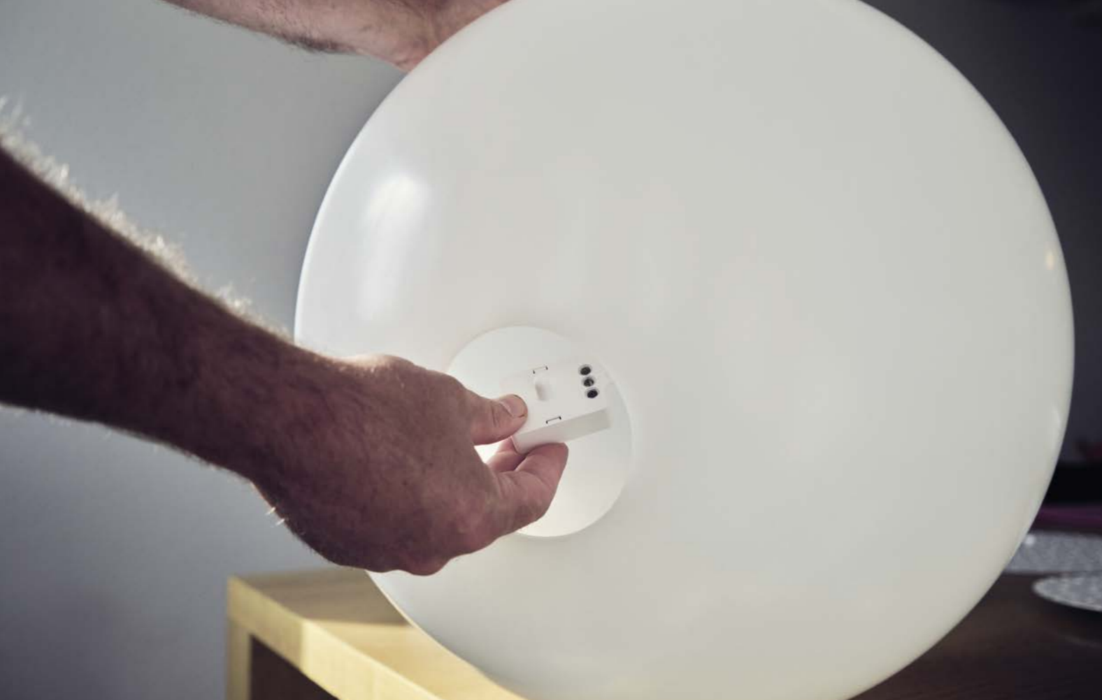
Die grösste Herausforderung bei der Integration von Sensorik in bestehende Leuchten ist die Konstantlichtregelung, bei der das Eigenlicht kompensiert werden muss, um den Tageslichtanteil korrekt zu messen. (Fotos: zVg.)
